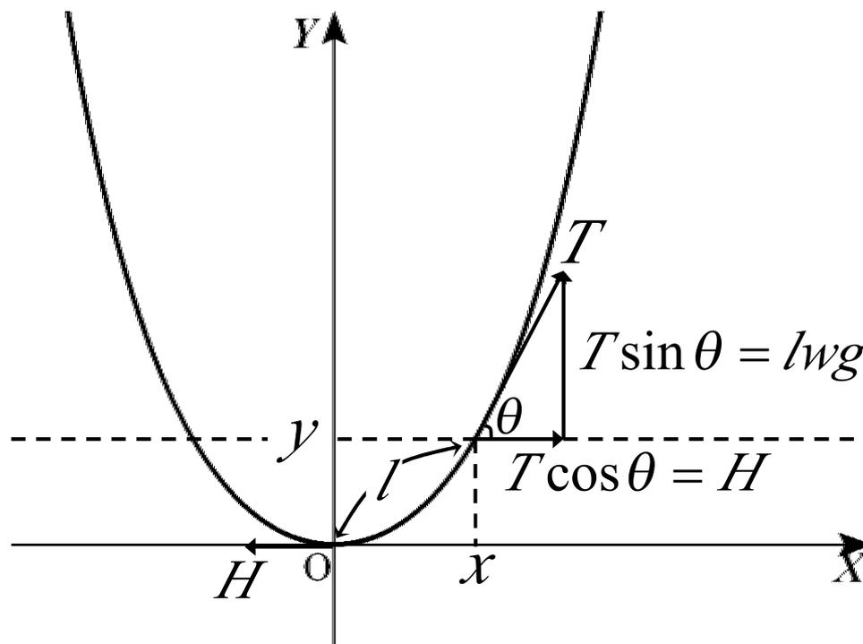
上の図を、ロープを左右から吊ってできる図を表すものとします。ロープが最も地面に近づく点を原点  $(X, Y) = (0, 0)$  にとると、このロープが作る曲線は  $Y$  軸対象となるので、以後簡単のため  $x \geq 0$  の部分について議論することにする。このとき、座標  $(X, Y) = (x, y)$  でのロープの状態を考えると、この点でロープに働く力はある。この点に働く力は、 $(X, Y) = (x, y)$  と、 $(X, Y) = (-x, y)$  の 2 点から吊っている場合と等しくなることに注意すると、
